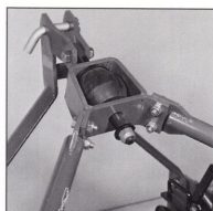
Gummidämpare som skyddar harv och traktor.
